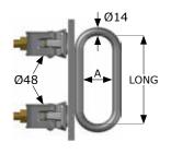
Accesorio de elevación para estructuras tubulares de andamio de tubo redondo de 48mm de diámetro.
