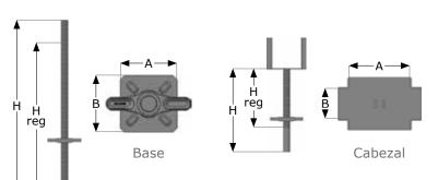
Fabricados con barra maciza roscada Ø38 mm.
